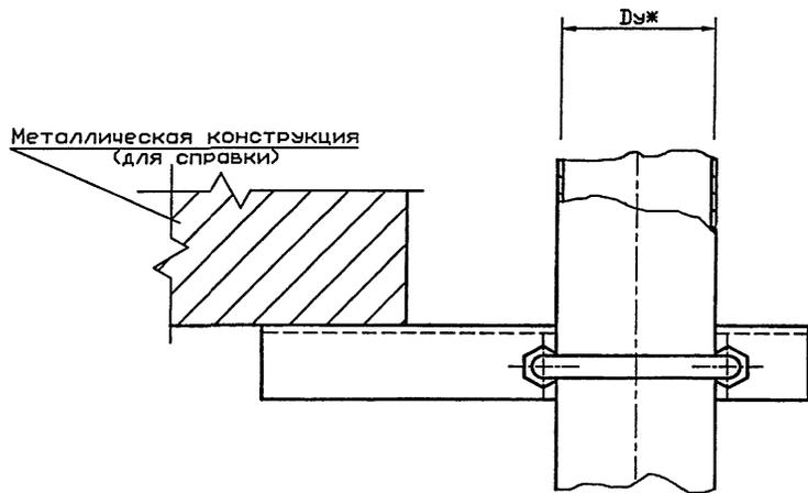
1. Для крепления газопроводов к кронштейну возможно применение хомутов из круга 8-В ГОСТ 2590-88 согласно чертежу УКГ 11.03 с уменьшением диаметров отверстий под хомуты до 10 мм.
