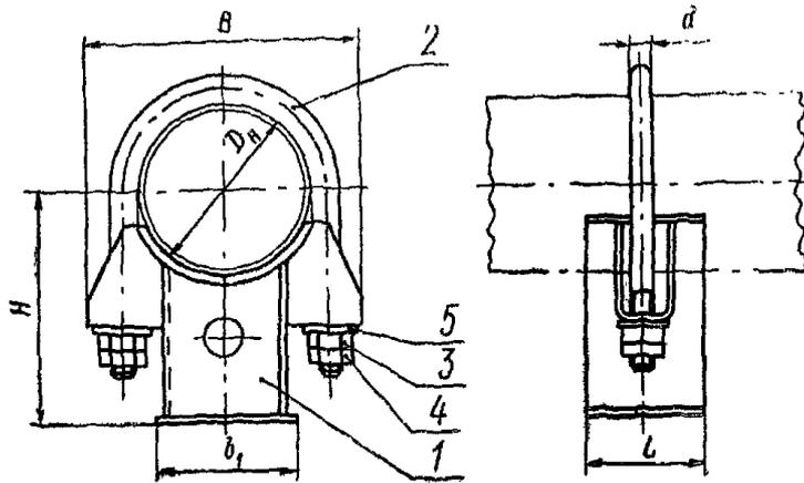
1 — корпус; 2 — хомут; 3 — гайка низкая; 4 — гайка; 5 — шайба
